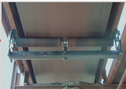
Tru-Trainer duplo trabalhando de forma fantástica, em um transportador de minério FPM850, 200 PIW.
