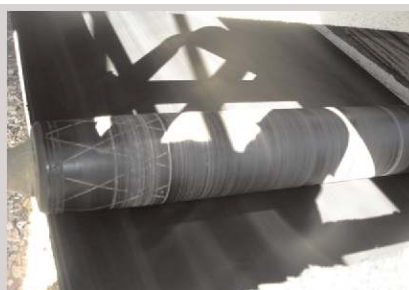
O Tru-Trainer instalado nesta Esteira Chevron elimina a vibração.
