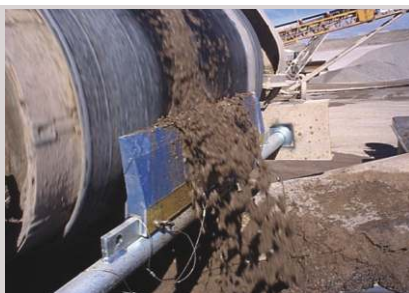
Sistema Skalper III trabalhando com sucesso, evitando o retorno de qualquer areia molhada.
