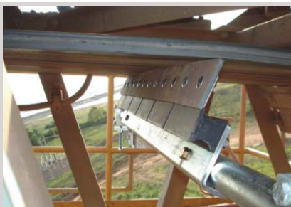
O limpador de esteiras secundário Razor-Back oferece remoção eficaz de resíduos.
