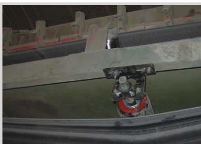
Tru-Trainer empurrando no lado limpo da esteira nesta fábrica de cimento.
