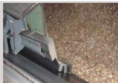
Montagem com grampo Lowboy e Tri-Seal instalado em canaleta de liberação
