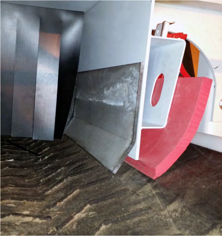
Revestimiento de faldones internos.
