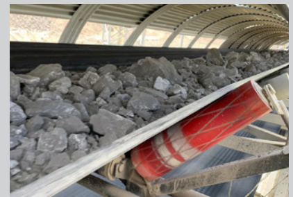
Rodillo de Carga Cónico en Uretano Tru-Trainer®
