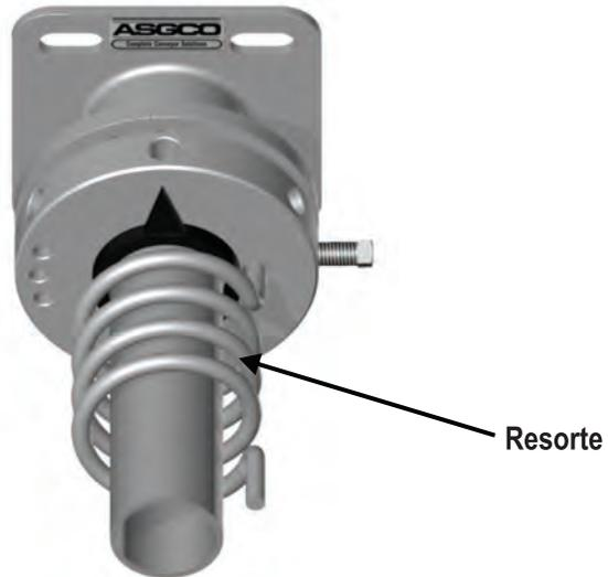
Inserte un extremo del resorte dentro del collar tensor interior. El extremo del resorte debe ser ajustado a través de todo el collar. El anillo debe poder moverse libremente durante toda la instalación. No apriete el tornillo de fijación hasta que los dos collarines estén en su lugar.
