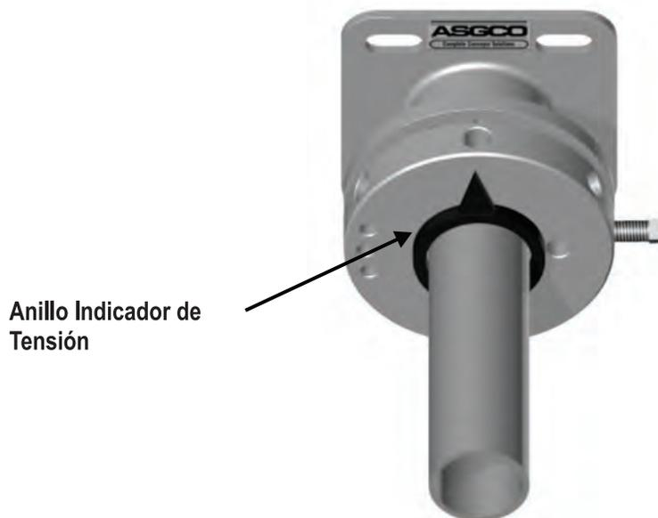
Deslice el anillo sobre el tubo de montaje, nivelar con el casquillo UHMW. No apriete los tornillos de fijación en el anillo en este paso.
