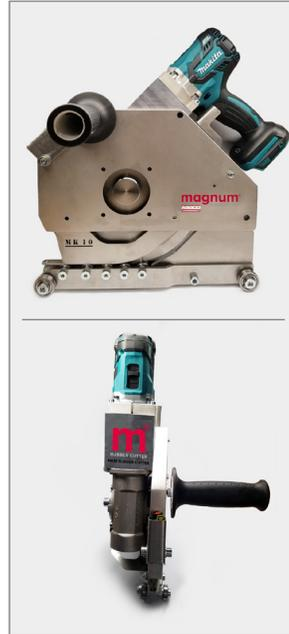
El ASGCO Magnum® Belt Cutter corta correas transportadoras straight-warp y con capas de lona, así como caucho no reforzado. La placa base está diseñada para reducir el arrastre de la goma, rueda suave y fácilmente sobre la superficie de trabajo. Todas las piezas están mecanizadas a partir de una aleación de aluminio de aviación y encajan entre sí, lo que elimina las piezas soldadas y los problemas de flexión, torsión o corrosión ambiental.
