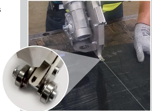
La guía asegura un corte de precisión
